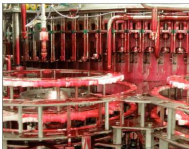
Die Durchführung umfasst die Bewertung der Programmstruktur, der Schaumqualität, die Intensität der Spritzdrücke, sowie die einwandfreie Abspülung der Maschinenoberflächen und Bauteile.
